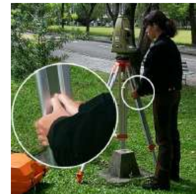
Calar a nivela esférica utilizando os movimentos de extensão do tripé
