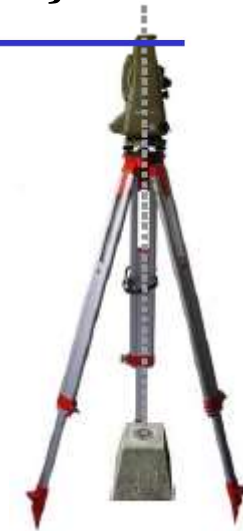
Eixo principal do aparelho passando pelo ponto estação utilizando o prumo óptico ou laser
